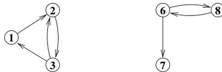
Abbildung 3.3: Beispiele für induzierte Teilgraphen des Graphen  $G_2$  aus Abbildung 3.1. Links der Teilgraph, der durch die Knotenmenge  $\{v_1, v_2, v_3\}$  induziert wird und rechts der Teilgraph der durch die Knotenmenge  $\{v_6, v_7, v_8\}$  induziert wird. Zusammen ergeben sie den Teilgraphen, der durch die Knotenmenge  $\{v_1, v_2, v_3, v_6, v_7, v_8\}$  induziert wird.
