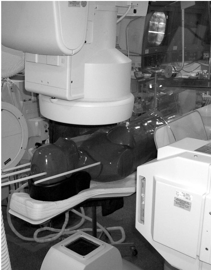
**Abbildung 3: Untersuchungsaufbau an der biplanaren Angiographieanlage, rechts des Phantoms positionierter baulicher Strahlenschutz.**
