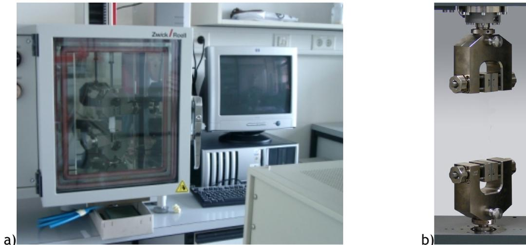
Abb. 4.8: a) Zugprüfmaschine Zwick 2.5N mit Wärmekammer<sup>[71]</sup> b) Einspannbacken im Detail<sup>[72]</sup>
