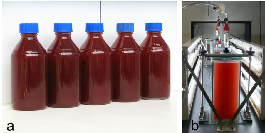
**Abbildung 8.1:** a: 1 L Kulturen, b: Angeimpfter, belichteter 60 L Glasfermenter mit Gasansätzen und pH-Elektrode.
