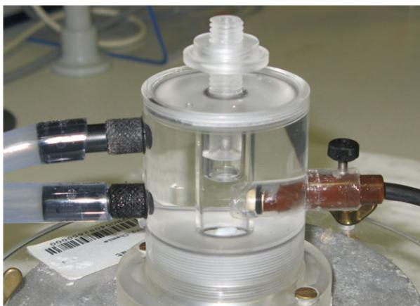
**Abbildung 9.3:** Polarographisches System aus Platin-Anode und Silber-Kathode zur Ermittlung der spezifischen  $\text{H}_2$ -spaltungsaktivität des Enzyms. Die Elektrodenanordnung ist seitlich in einer Messzelle angebracht. Die Zelle wird mit einem angeschlossenen Wasserthermostat auf  $30^\circ\text{C}$  temperiert und ist auf einem Rührgerät montiert.
