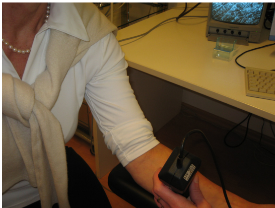
Abb. 3-3 Messung der Oberflächenstruktur der Haut mit dem SELS-Verfahren
