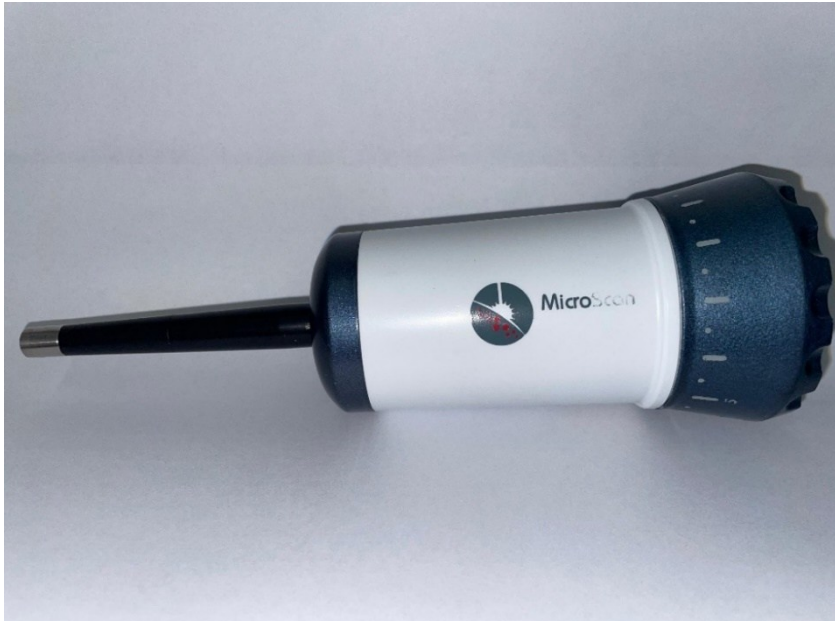
Abb. 2: Darstellung des Intravitalmikroskops. Bildliche Darstellung des Intravitalmikroskops MicroScan® Video Microscope (MS-02) der Firma MicroVision Medical (Amsterdam, Niederlande).
