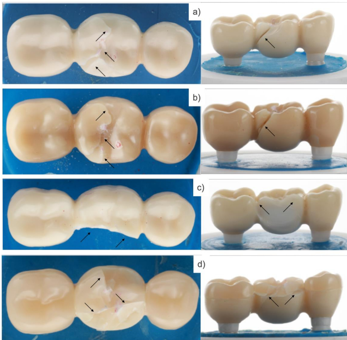
Abb. 22: Frakturmodi der Gruppen nach Bruchbelastungstest. Pfeile verdeutlichen die Hauptfraktur.
