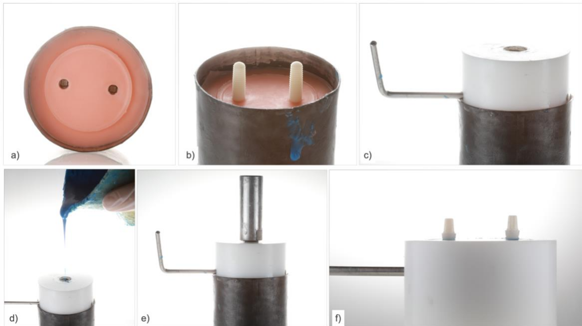
Abb. 11: Einbetten der Implantate in die Probenhalter: (a) Konter mit fixierten Schutzkappen, (b) Eingesetzte Implantate, (c) Konter mit aufgesetztem Probenhalter mit Metallstift, (d) Einfüllen von Ren Cast, (e) eingeschraubte Halteschraube, (f) fertig ausgehärteter Prüfkörper mit korrekter Implantatposition.
