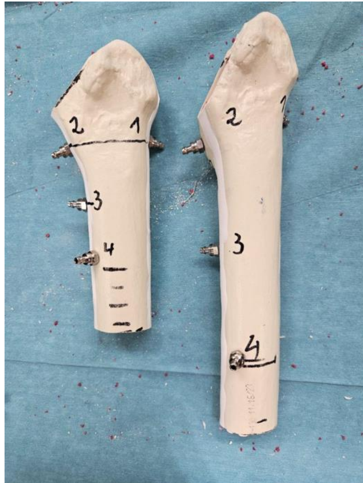
Abb. 8: Position der Druckmesspunkte
