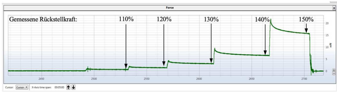
Abb. 8 Messung der passiven Rückstellkraft
