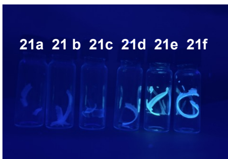
Abbildung 32: Festkörperemission der Verbindungen 21 eingebettet in einer PMMA-Matrix (1 Gew.%) unter UV-Licht ( \lambda_{exc.} = 365 nm).
