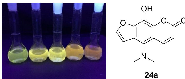
Abbildung 49: Emission der Verbindung 24a in Toluol, EtOAc, THF, CH 2 Cl 2 und MeCN ( \lambda_{\text{exc}} = 365 \text{ nm} ).
