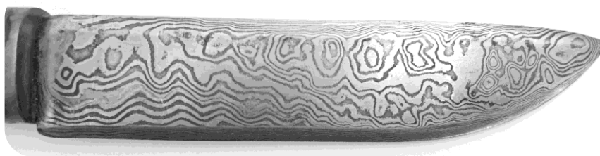
Abbildung 2-1: Klinge aus Damaszenerstahl mit markantem, wellenförmigen Oberflächenmuster (Damast).
