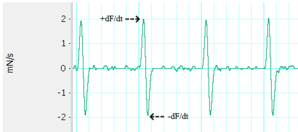
Abb. 10: Ausschnitt einer Originalmessung der Geschwindigkeit des Kraftanstiegs und -abfalls. Die Geschwindigkeit des Kraftanstiegs ( +dF/dt ) und die Geschwindigkeit des Kraftabfalls ( -dF/dt ) werden in Millinewton pro Sekunde (mN/s) gemessen. Die +dF/dt wird am maximalen Punkt der Kurve und die -dF/dt am minimalen Punkt der Kurve abgelesen. Die Signale wurden mit Hilfe des Programms LabChart aufgezeichnet.
