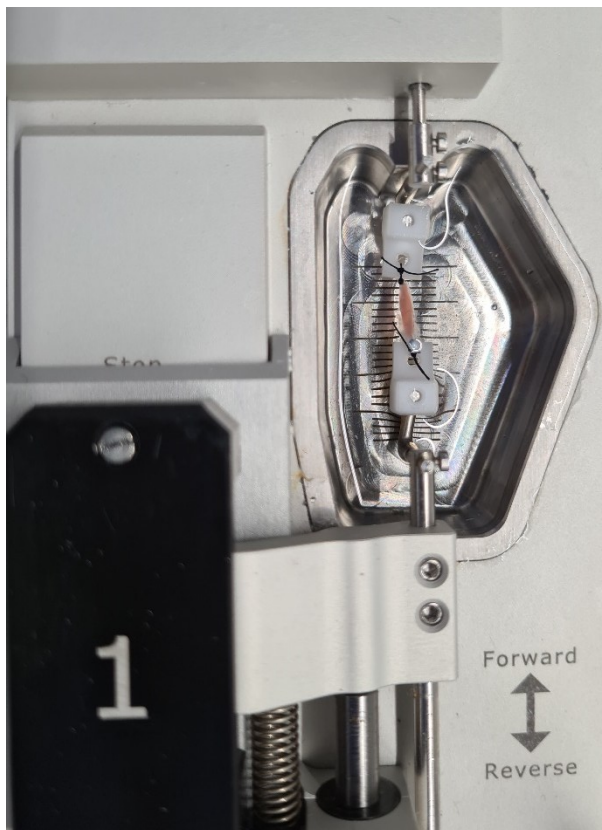
Abb. 10 präparierter und eingespannter Musculus soleus
