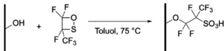
Schema 24: a) Verwendung eines Chipreaktors zur quantitativen Entschützung von Benzaldehyddimethylacetat ( 38 ) und b) Oberflächenfunktionalisierung der Glaschipreaktors mittels einer starken Perfluoroalkylsulfonsäure in Toluol. [104]
