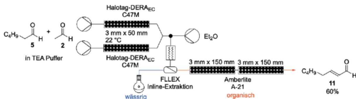
Schema 4: Experimenteller Aufbau der kontinuierlichen zweistufigen Synthese des \alpha,\beta -ungesättigten Aldehyds ( E )-Octenal (11) im Flow-Modus.
