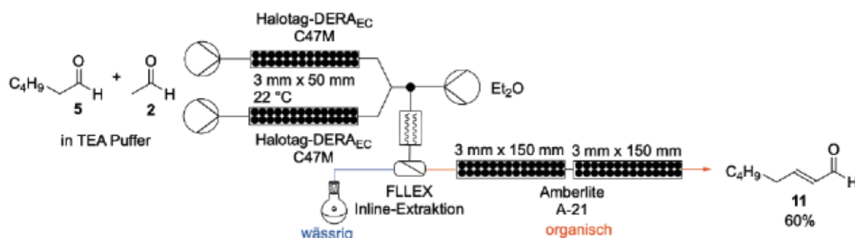
Schema 45: Experimenteller Aufbau der kontinuierlichen zweistufigen Synthese des \alpha,\beta -ungesättigten Aldehyds ( E )-Octenal (11) im Flow -Modus bei Kombination eines DERA-katalysierten Reaktionsschrittes zum 3-( R )-Hydroxyoctanal (6) und eine sequenzielle In-line-Eliminierung katalysiert mit einem basischen Ionenaustauschharz A-21. Parallele Verwendung zweier Festbettreaktoren ( \varnothing 3 mm, L 50 mm) gepackt mit Halo-DERA EC -C47M. Nach Extraktion und Phasentrennung, wurde das Reaktionsgemisch durch zwei in Reihe geschaltete Festbettreaktoren beinhaltend A-21 ( \varnothing 3 mm, L 150 mm) zur Eliminierung von Wasser gepumpt. 60 % (isoliertes Produkt über zwei Stufen) des \alpha,\beta -ungesättigten Aldehyds ( E )-Octenal (11) wurden isoliert.
