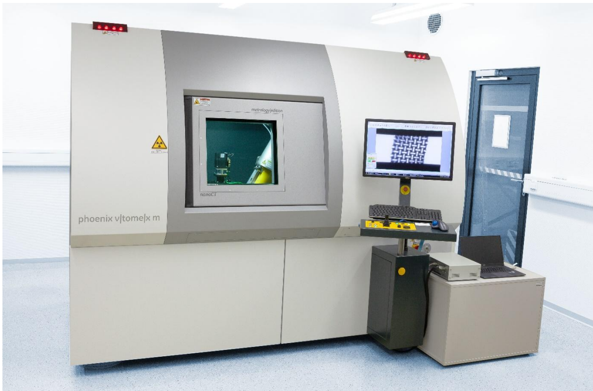
Abbildung 9: \mu CT-Gerät „Phoenix V|tome|x M“ im Fraunhofer EMI. Hinter dem mittleren Fenster ist ein Blick in die Messkammer zu werfen. Rechts steht die dazugehörige PC-Einheit, für die Messeinstellungen.
