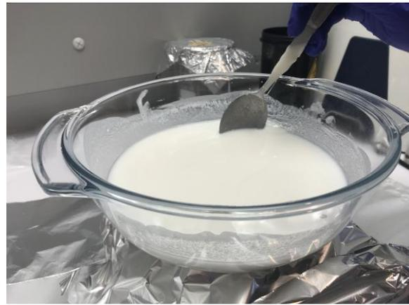
**Abb. 5: Zubereitung des weichgewebssimulierenden Materials (Mix-D) auf einer Heizplatte und unter einer Dunstabzugshaube**
