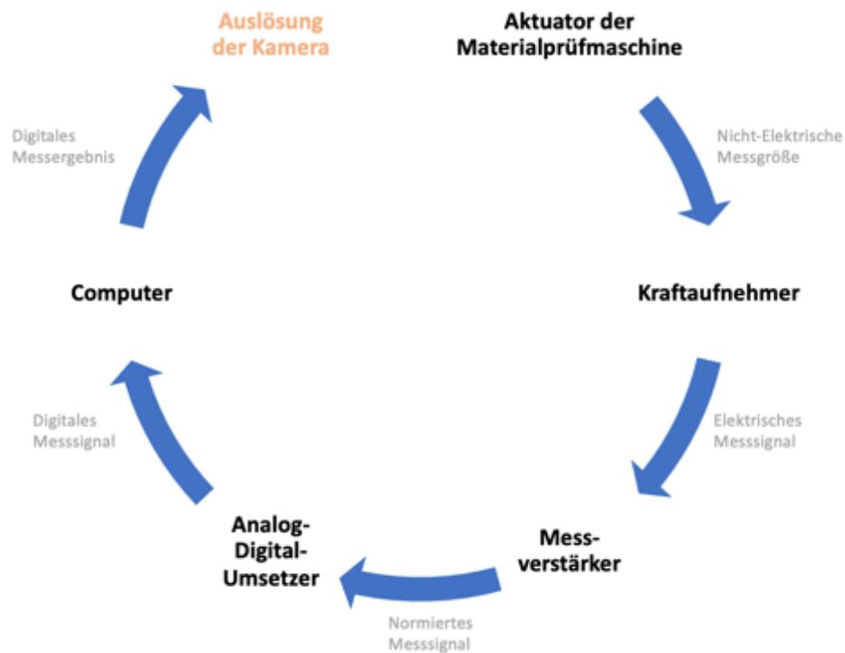
Abb. 28: Modifizierte Messkette nach DIN 1319-1
