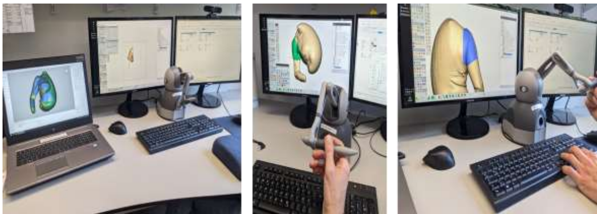
Abb. 19: Datenbearbeitung mittels Modulationssoftware unter Verwendung eines 3D-Stiftes zur multidimensionalen Verarbeitung.
