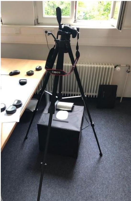
**Abb. 9** Aufbau der standardisierten Kameraapparatur inklusiv Stativ und Fotobox.
