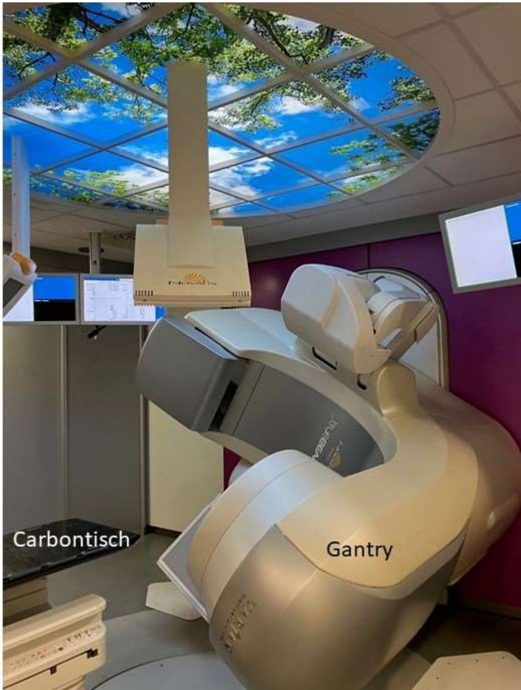
**Abbildung 4:** Linearbeschleuniger zur Durchführung einer niedrig dosierten Radiotherapie beim Fersensporn. Auf dem Bild sieht man die Gantry und den Carbontisch.
