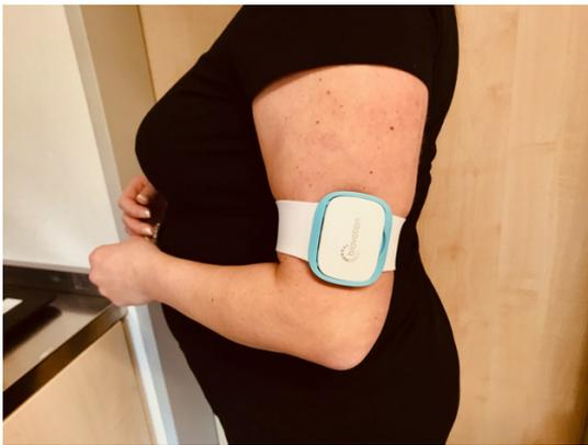
Abbildung 1: **Positioniertes Gerät am Oberarm** mit passendem Armband 2-3 cm oberhalb der Ellenbeuge
