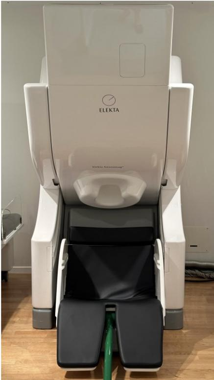
**Abb. 3:** Das 306-Kanal-Ganzkopf-MEG-System (Elekta Neuromag®, Elekta, Helsinki, Finnland) des Universitätsklinikums Düsseldorf. Die Sensoren bestehen aus 102 Triple-Sensor-Elementen, jeweils bestehend aus einem Magnetometer und zwei orthogonalen planaren Gradiometern.
