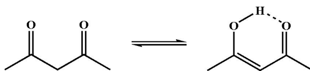
Abb. 1.4: Keto-Enol Tautomerie zur Bestimmung der Polarität von ILs
