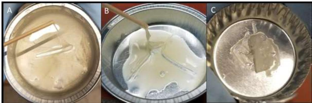
Abbildung A.10-7: A) PU-S2 mit Omnirad BP als Photoinitiator nach Bestrahlung bei 365 nm für 60 s in der LED-Kammer. Nur geringfügige Vergelung beobachtet. B) PU-S3 mit Esacure 1001 M als Photoinitiator nach Bestrahlung bei 365 nm für 60 s in der LED-Kammer. Stärkere Vergelung beobachtet. C) PU-S5 mit Omnirad BP als Photoinitiator nach Bestrahlung bei 365 nm für 60 s in der LED-Kammer. Starke Vergelung beobachtet. Fotos aufgenommen von C. Choi.<sup>[183]</sup>
