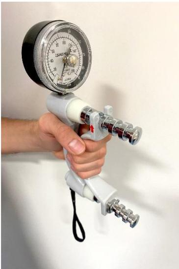
**Abb. 4: Untersuchungsgerät Handgrip-Dynamometer.**
