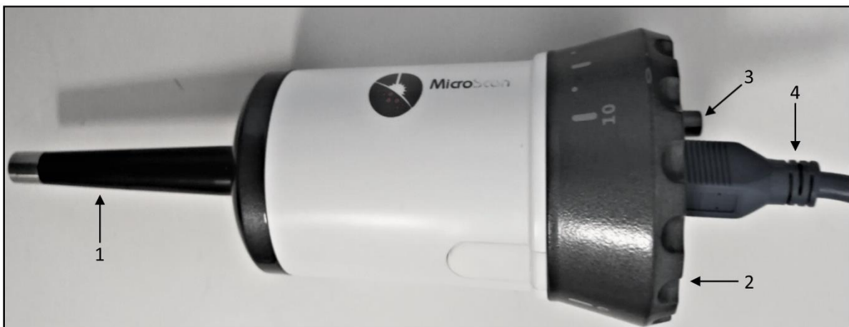
Abb. 5: MicroScan Intravitalmikroskop. 1 = Sonde mit Leuchtdioden, 2 = Fokussierungsring, 3 = Eject -Knopf zur Entfernung der Einweg-Linse, 4 = USB 3.0 Kabel
