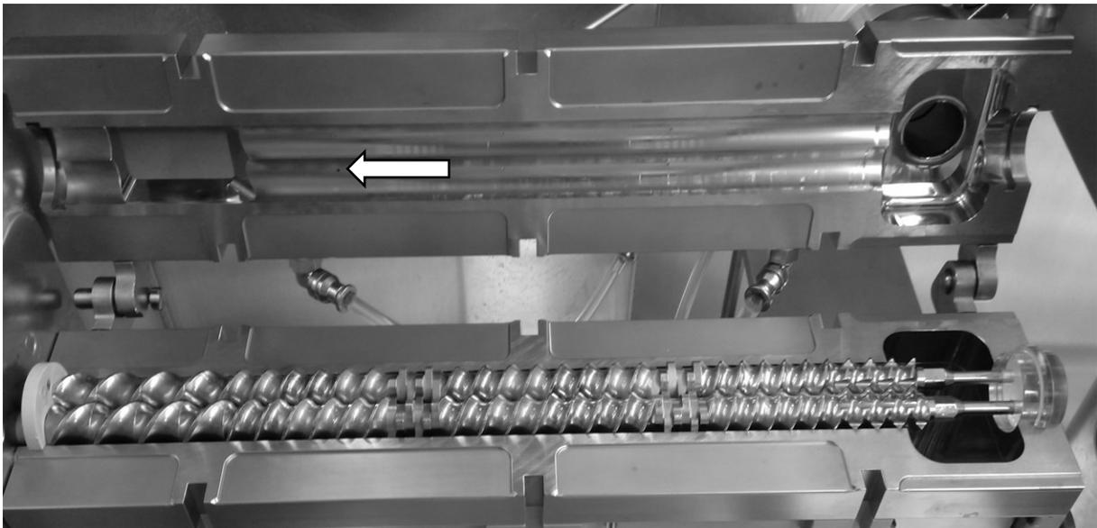
Abbildung 4: Granulierschnecken im aufgeklappten Gehäuse. Die Öffnung zur Zugabe der Granulierflüssigkeit ist markiert.
