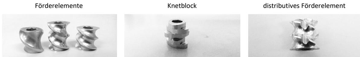
Abbildung 3: Schneckenelemente bei der Zweisechnecken-Feuchtgranulierung: Fördererlemente unterschiedlicher Ganghöhe, Knetblock und distributives Fördererlement.
