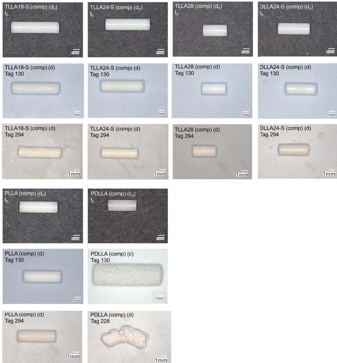
**Abbildung 48.** Untersuchung des Abbaus bei 37°C von Implantaten, die aus verschiedenen Oligomeren / Polymeren (TLLA18-S, TLLA24-S, TLLA28, DLLA24-S, PLLA, PDLLA) per Kompression (comp) hergestellt wurden. Digitalmikroskopische Aufnahmen vor Beginn der Abbaustudie ( $t_0$ ) im trockenen Zustand ( $d_0$ ) im Vergleich zu den Proben nach 130 Tagen bzw. nach 228 oder 294 Tagen im trockenen Zustand (d), Maßstabskala 1 mm (eine repräsentative Probe von  $n=3-21$ ).
