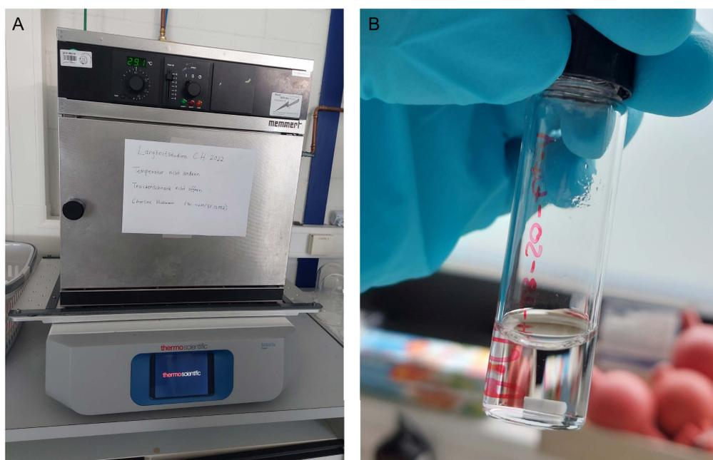
**Abbildung 8.** (A) Der Trockenschrank auf dem Orbitalschüttler und (B) ein exemplarisches 5 ml Schraubdeckelgefäß mit einer Probe in 2 ml Puffermedium.
