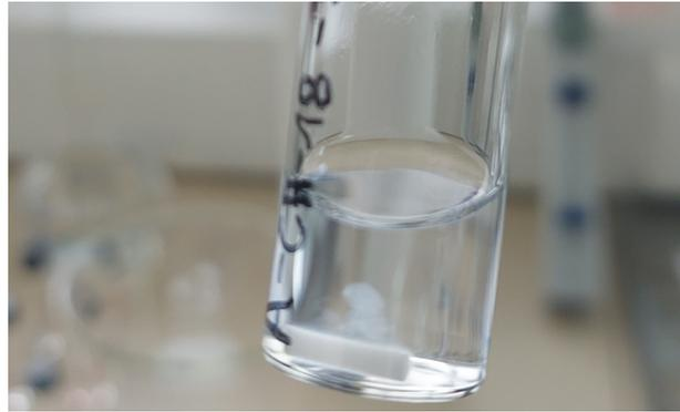
**Abbildung 55.** Aus dem Implantatbulk ausgetretenes Abbauprodukt während des Abbaus unter beschleunigten Bedingungen (60 °C). Exemplarisch gezeigt an einem gepressten Implantat von TLLA18-S nach 3,5 Tagen.
