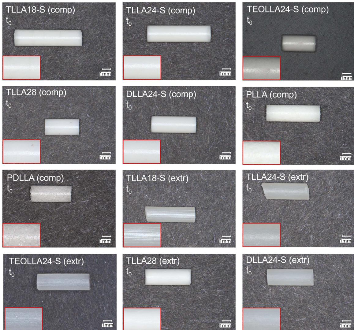
**Abbildung 20.** Digitalmikroskopische Aufnahmen der Implantate nach der Herstellung ( $t_0$ ) mittels Kompression (comp) oder Extrusion (extr), Maßstabskala 1 mm, der rot umrandete Bereich zeigt einen um 75 % vergrößerter Bildausschnitt (eine repräsentative Probe von  $n=12-42$ ).
