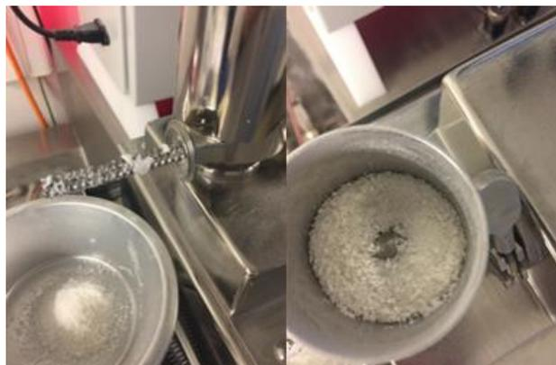
Abbildung 4.1.2 Beispiele der Materialverformung während der gravimetrischen Dosierung, Links: Kleben und Blockieren der Dosierschnecke, Rechts: Granulatbildung von feinem Pulver im Füllschuh
