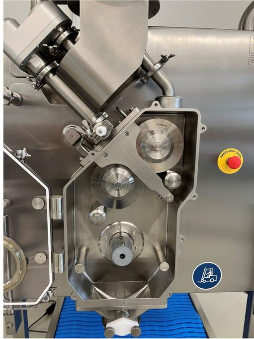
*Abbildung 3.8. Gerteis MINI-POLYGRAN<sup>®</sup> ausgestattet mit einer Herzabdichtung und glatten Walzen mit 150 mm Durchmesser. Die Granuliereinheit wurde ausgebaut.*
