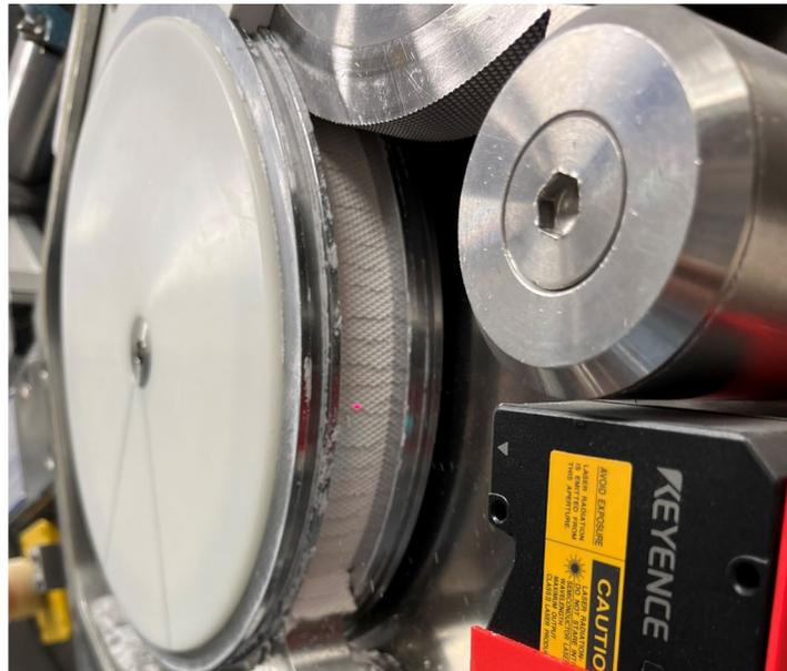
*Abbildung 3.22. In-line Triangulationslasermessung unter der Benutzung von gerändelten Walzen mit MCC.*
