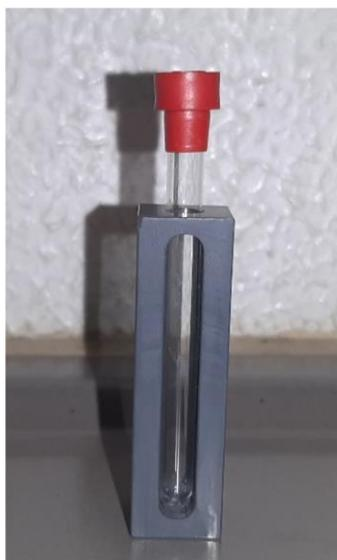
**Abbildung 121:** Gekürztes NMR-Röhrchen mit Deckel zur Aufnahme von Absorptionsspektren in einer Haltevorrichtung.
