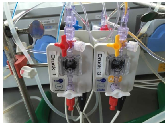
Abb. 3: Messgeräte für Druckerfassung und Steuerung
