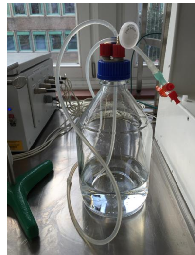
Abb. 5: Darstellung einer 2L großen Glasflasche von Schott zur Wiederauffüllung der Dezellarisierungs-Lösung
