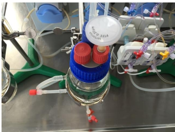
Abb. 1: speziell modulierte Perfusionsflasche mit Spezialdeckel und Ventil und Filter
