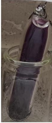
**Abbildung 39:** Sublimation von Iod während der Reaktion.
