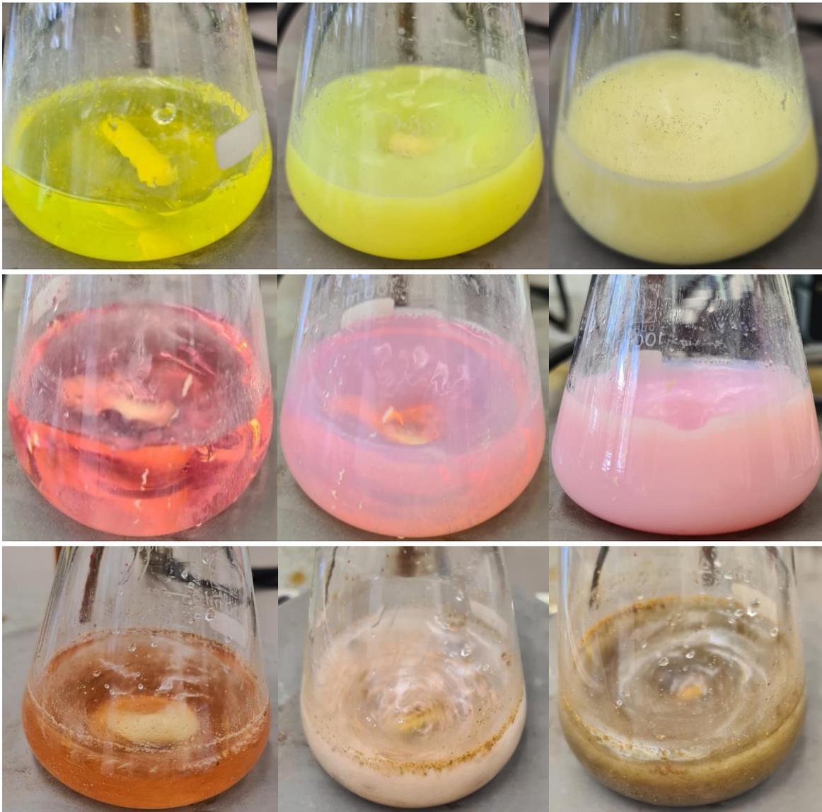
**Abbildung 83:** Optischer Verlauf der Titration des Chloridgehalts von **1** (oben), des Bromidgehalts von **2** (mittig) und des Iodidgehalts von **3** (unten).
