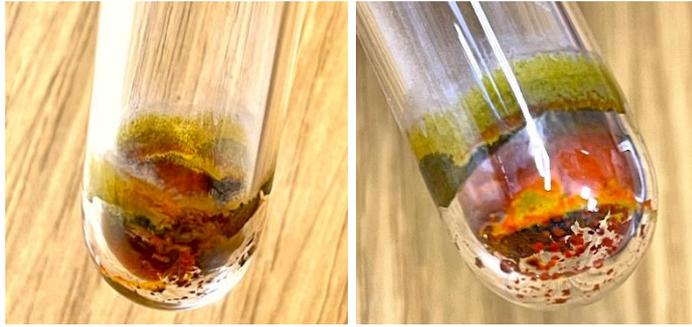
**Abbildung 40:** Schmelzkuchen nach der Umsetzung im Muffelofen.
