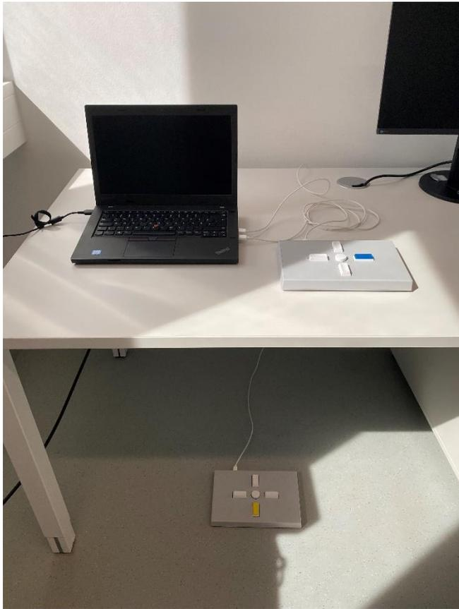
**Abb.2. Versuchsaufbau.** Das Handreaktions-Pad wurde zur Betätigung mit der rechten Hand auf dem Tisch platziert, das Fußreaktions-Pad wurde zur Betätigung mit dem rechten Fuß unter dem Tisch platziert. Die farbige Markierung der zu betätigenden Tasten (gelb/blau) konnte je nach Zuordnung von Farbe und Effektor angepasst werden.
