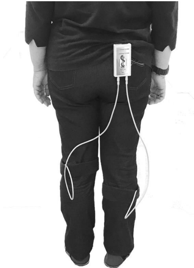
Abb. 10: Rückansicht des Ganganalysesystems Sichtbar ist die portable Aufzeichnungseinheit.
