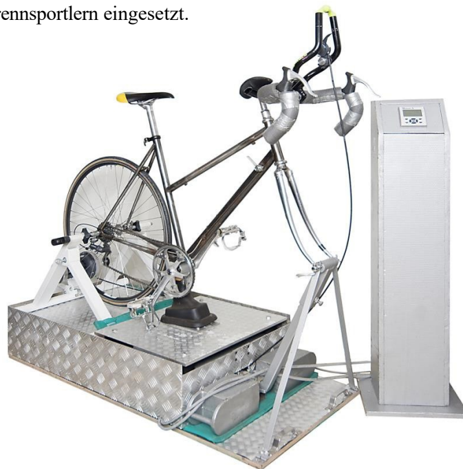
Abb. 13: Für die Spastik-Studie verwendeter Prototyp des Vibrationsergometers
