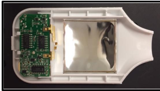
**Abbildung 3 – Adasuve® -Gerät in geöffnetem Zustand.**
