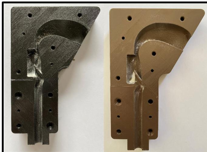
**Abbildung 19 – Makroskopisch sichtbare extrathorakale Deposition im dem Rachenmodell aus TPU 98 (links) und PETG (rechts).**
