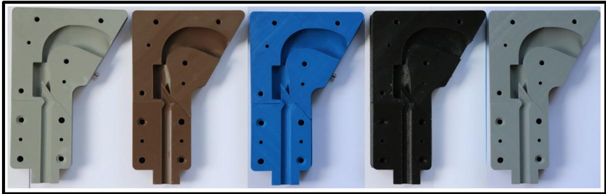
Abbildung 16 - Rachenmodell aus PLA, PETG, ABS, TPU 98 und ASA (von links nach rechts).
