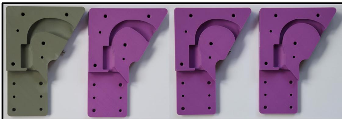
**Abbildung 42 - Rachenmodelle mit modifiziertem Zungenvolumen** (von links nach rechts: Originalmodell, Zunge + 5050, 8000 und 10200 mm<sup>3</sup>).
