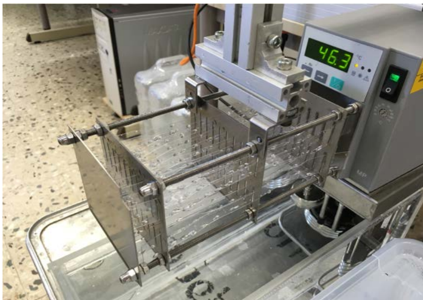
Abb. 2: Probekörperträger des Thermozyklrier-Aufbaus
