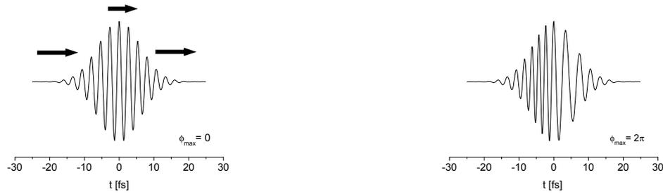
**Abb. 5** – Verformung des zeitlichen Pulsprofils eines 10fs-Pulses durch SFM
