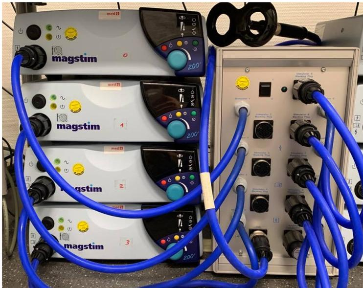
**Abb. 5: Aufbau des Quadripulsstimulation (QPS)-Apparates und achtförmige Magnetspule**
