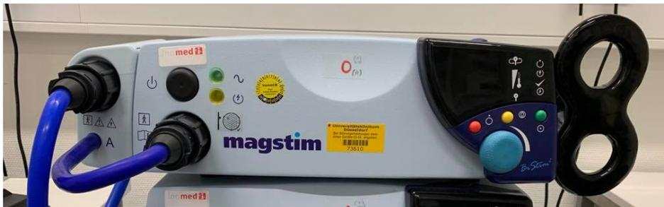
**Abb. 2: TMS-Generator und achtförmige Magnetspule**
