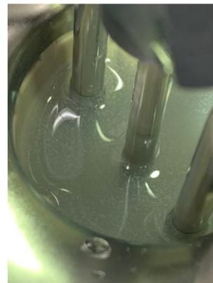
Abbildung 18: Partikelgrößenverteilungen einer Rivaroxaban-Nanosuspension (stabilisiert mit PVPK12 und SDS) gemessen in Wasser nach unterschiedlicher Verweilzeit im Vorlagebehälter des Laserbeugungsgerätes (links). Vorlagebehälter befüllt mit Rivaroxaban-Nanosuspension nach einer Stunde im verdünnten Zustand. Mikropartikel sind mit bloßem Auge erkennbar (rechts).
