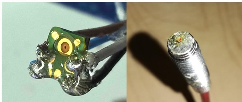
**Abb. 47: Gelötetes MEMS-Mikrofon SPM0408LE5H-TB zur Stabilität und besseren Beständigkeit gegen Kurzschluss mit Epoxidharz übergossen.**
