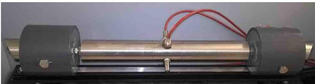
**Abb. 71: Bufferzelle 500mm: Bufferlänge 100mm, Buffer-Durchmesser 80mm; Rohrdurchmesser innen 5 mm. Abschluss mit gekippten Fenstern aus Saphir (2mm Dicke);  $CO_2$  aus der Umgebungsluft.**
