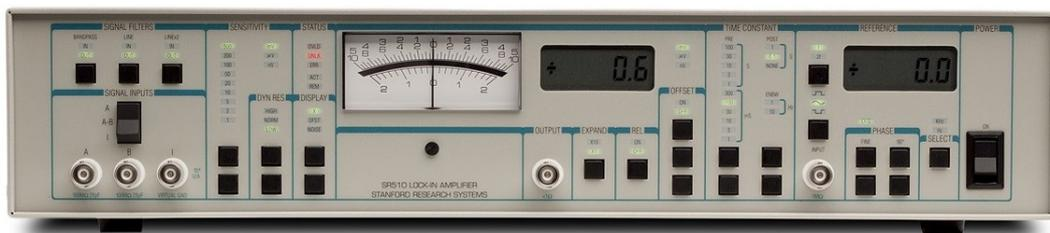
Abb. 51: Lock-In-Verstärker des Typs SR 510 der Fa. Scientific Instruments GmbH.
