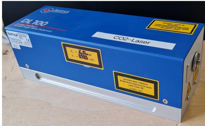
**Abb. 40: DFB-Lasers 2723 nm (für die CO<sub>2</sub> Anregung) mit 6,5 mW von der Fa. Toptica Photonics GmbH.**
