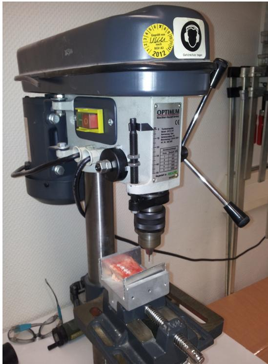
Abb. 5: Tischbohrmaschine Optimum B 14 T zur manuellen Vorbohrung.
