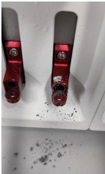
**Abbildung 94: Verwendete Pumpe für Durchflussreaktionen mit  $V_{Cl}PO-Ci$  nach einer Nutzung von 5 Tagen**
