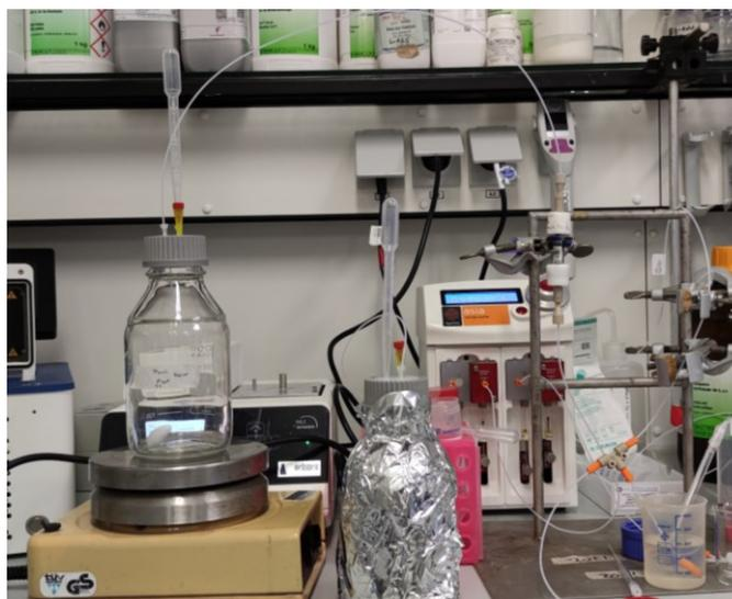
**Abbildung 100: Aufbau der Durchfluss-Anlage im Rahmen dieser Arbeit**
