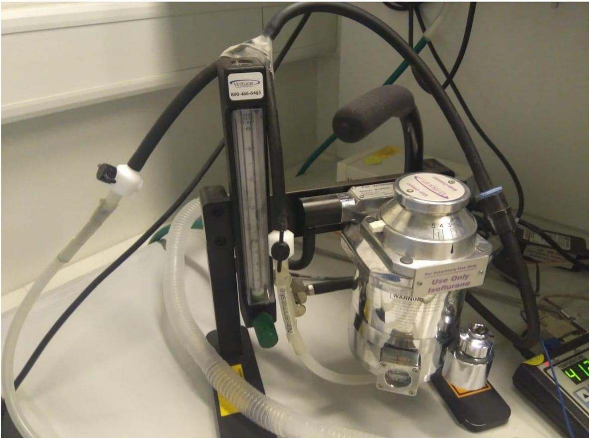
Abbildung 7: Gasmischer für die Mischung und Dosierung von Isofluran und Sauerstoff.
