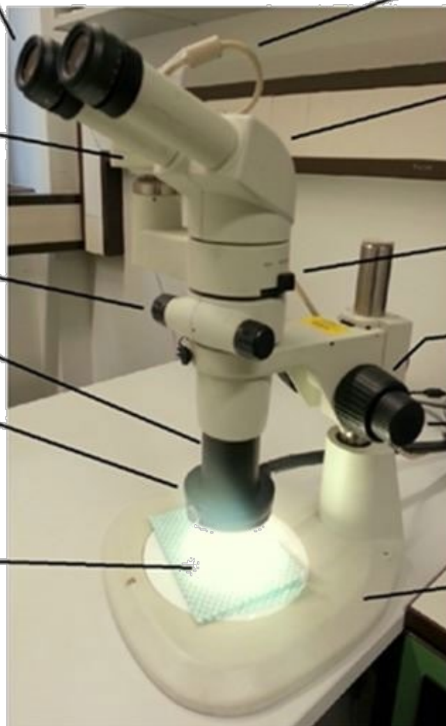
Abb. 2: Verwendetes Mikroskop „SMZ 800“ von Nikon, im Einsatz, mit Beschriftung
