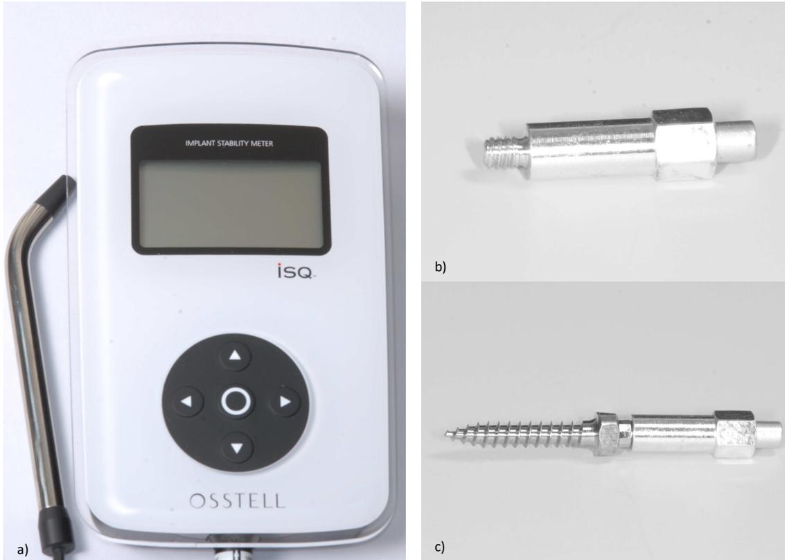
Abbildung 20a-b: verwendete Materialien zur Durchführung der ISQ-Messung
