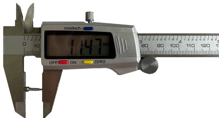
Abbildung 33: Messung der exakten Länge eines Benefit Mini-Implantates mit den Maßen 2 x 9 mm
