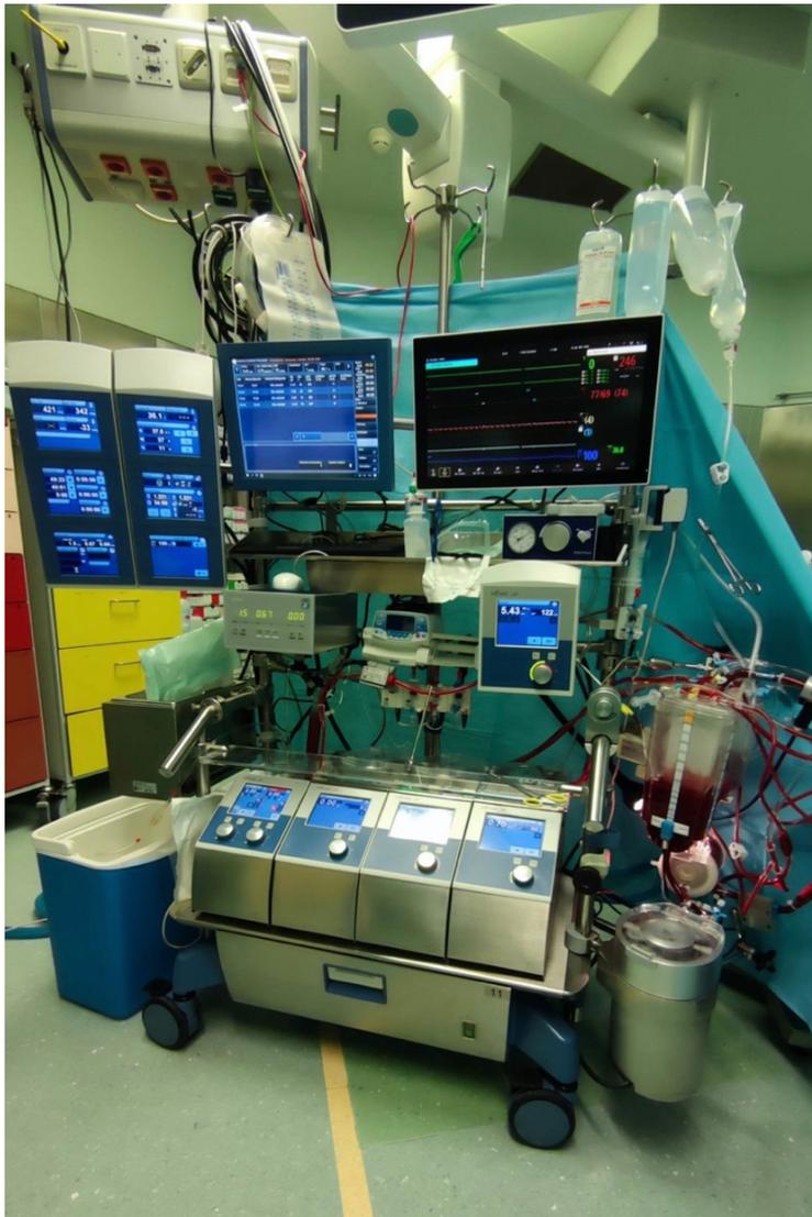
**Abb. 7: Die Herz-Lungen-Maschine.** Foto einer angeschlossenen HLM.
