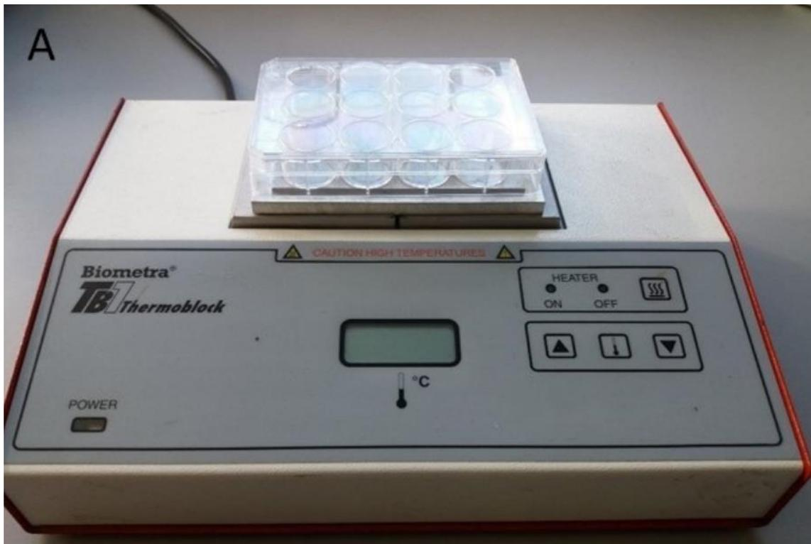
**Abbildung 3.1** zeigt den Versuchsaufbau des Kontaktverbrennungsmodells nach Wergen, dabei wird auf den Thermoheizblock eine hausgeigen hergestellte Aluminiumplatte zur gleichmäßigen Erhitzung der über ihr liegenden 12-Well-Platte gelegt. [60]
