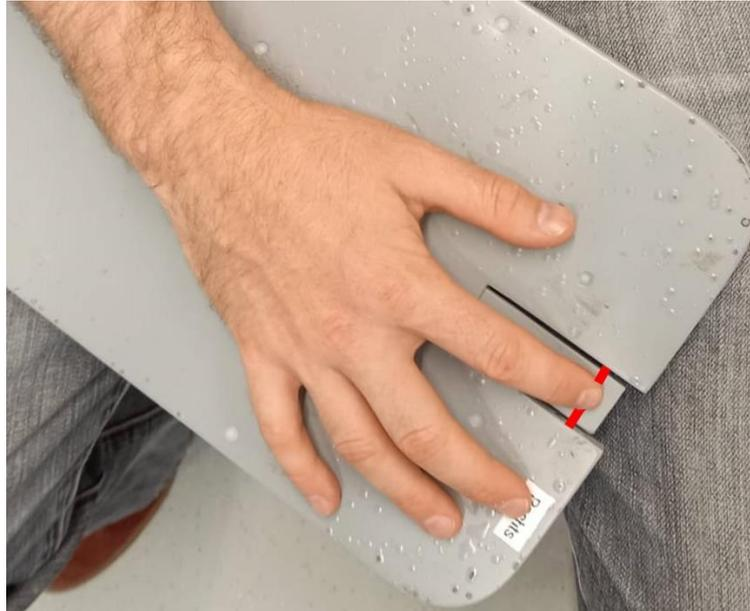
**Abb. 4: Tappingbrett zur Registrierung der Tap-Onsets.** Der rechte Zeigefinger befand sich über einem Feld mit integrierter Lichtschranke, die beim Tappen durchbrochen wurde. Die Lichtschranke ist hier schematisch in roter Farbe dargestellt.
