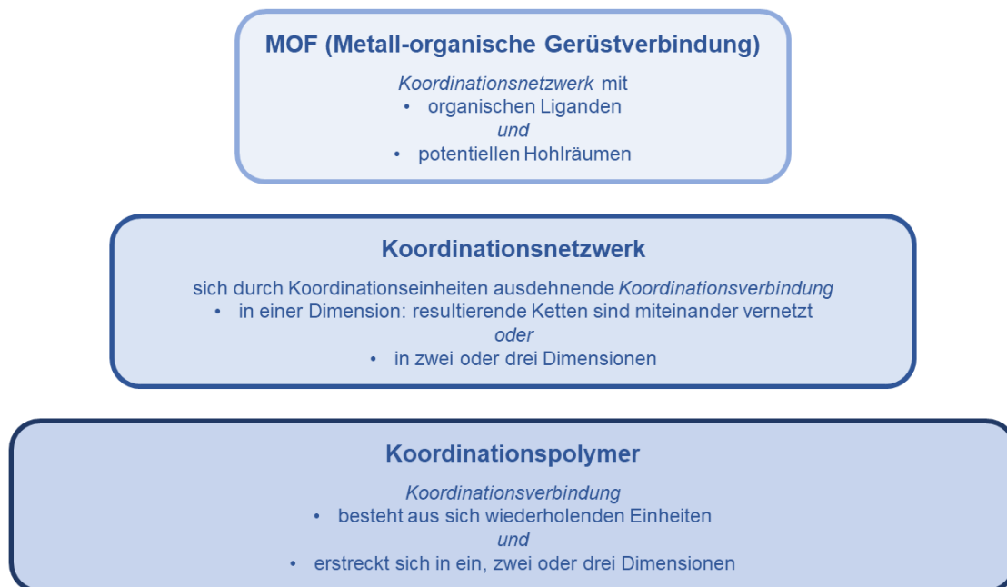
Abbildung 4 Schematische Darstellung der hierarchischen Terminologie von Koordinationspolymer, Koordinationsnetzwerk und metall-organische Gerüstverbindungen sowie Definition dieser Begriffe (IUPAC-Empfehlung 2013). 36,37
